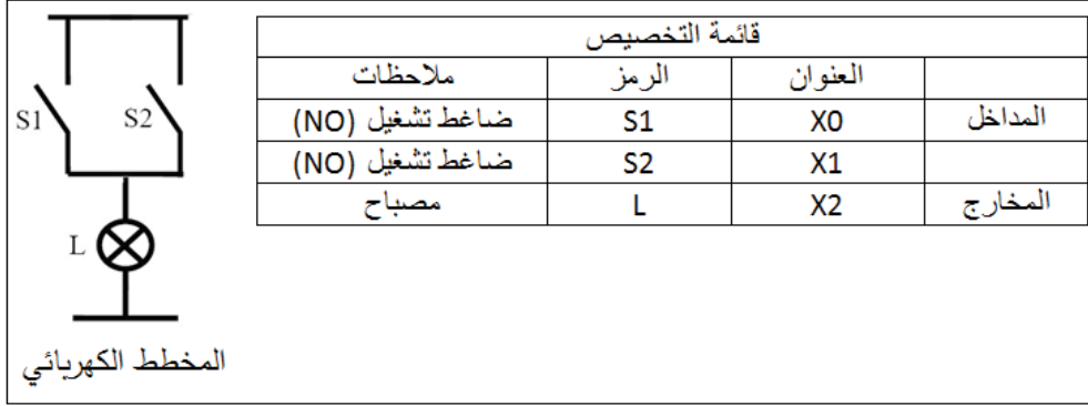
شكل (13): المخطط الكهربائي لتشغيل حمل بواسطة مفتاحين على التوازي
