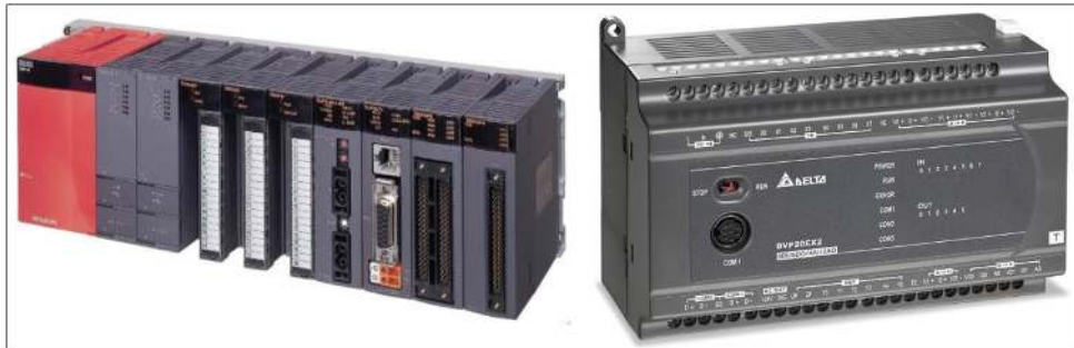
شكل(4): أشكال من أجهزة المتحكم المنطقي المبرمج PLC
