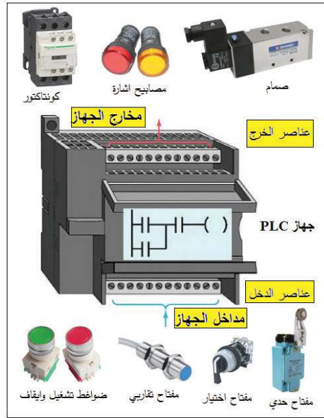
شكل (6): مبدأ عمل النظام الذي يستخدم جهاز PLC
